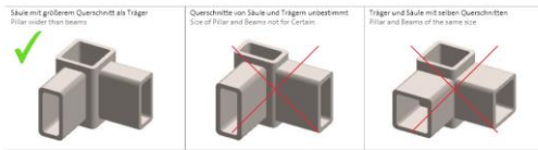
Skida mit größerem Querschnitt als Träger Pillar wider than beams Querschnitte von Säule und Trägern unebestimmt Size of Pillar and Beams not for Certain Träger und Säule mit selben Querschnitten Pillar and Beams of the same size
